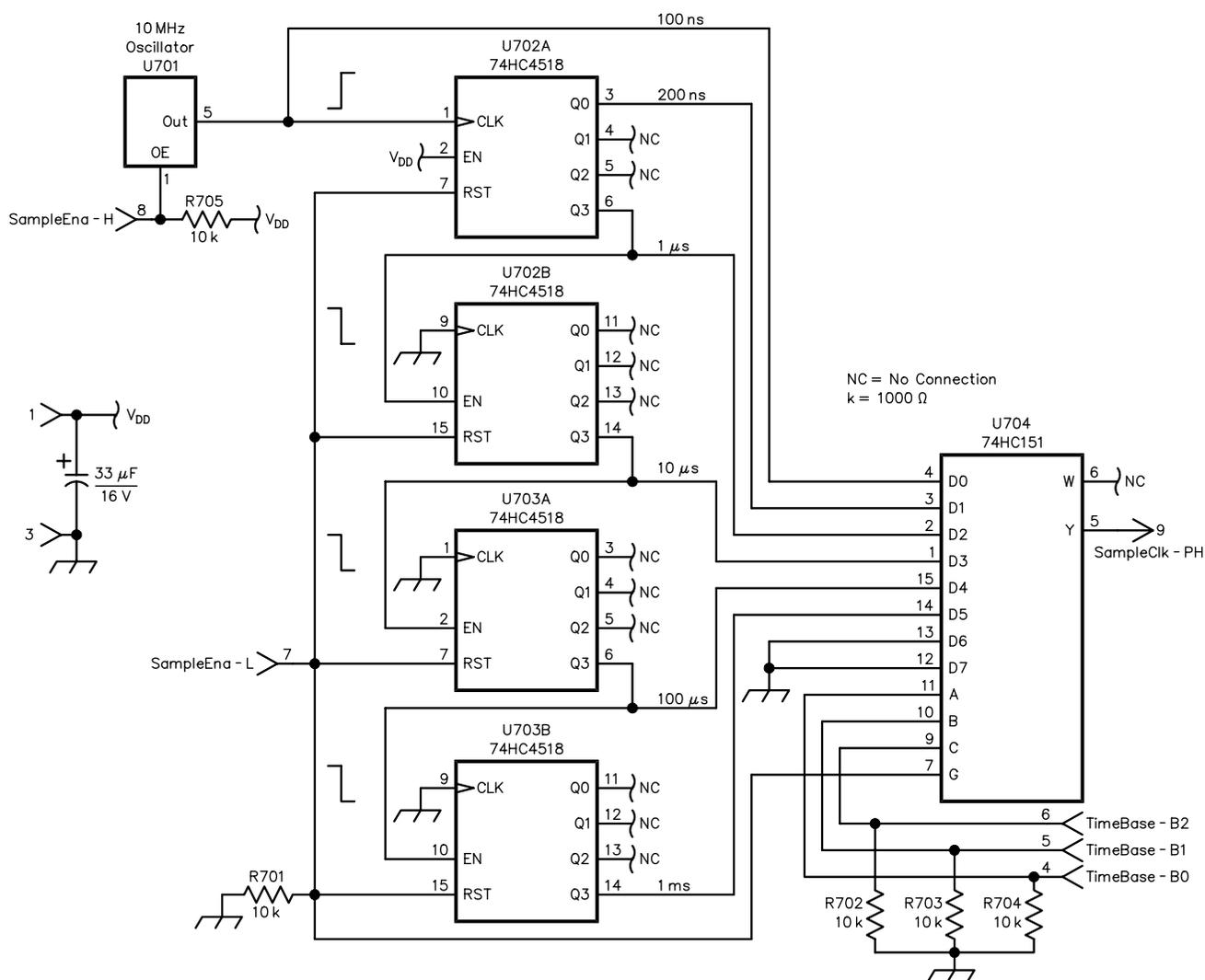
Fig 7—Time Base schematic diagram.
