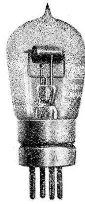
Obr. 27. Normální emise 10 mA uspokojí lampa Marconi R.
