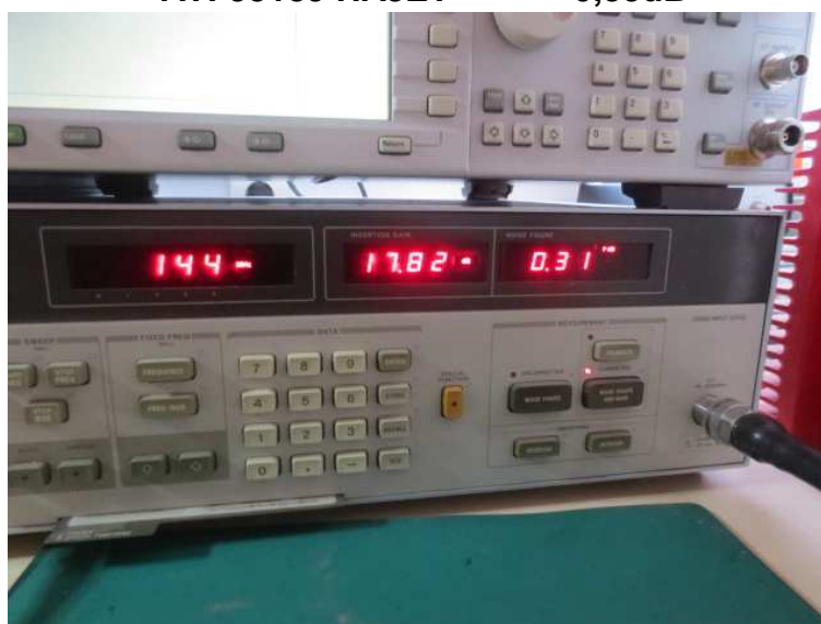
obr.č.7 Změřená hodnota šumového čísla a zisku na LNA z produkce HA8ET
